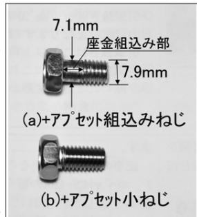
写真15 (a)M8x15の組込みねじの座金を除去したもの。 (b)通常の+アプセット小ねじ
