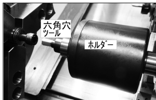
写真11 六角穴ツールを取り付けたホルダーを旋盤に設置
