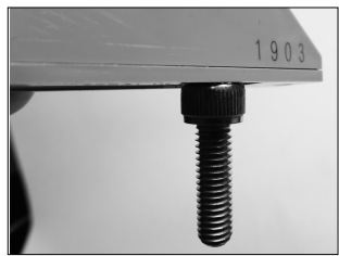
写真7 フェライト系ステンレスは磁石に付く (SUS430キャップスクリュー)
