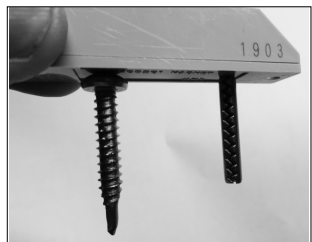
写真6 マルテンサイト系ステンレスは磁石に付く (左：SUS410ビーズPAN、右：SUS420J2波形ローレット)
