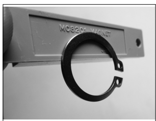
写真8 オーステナイト系は磁石に付く場合がある (SUS304CSP止め輪)
