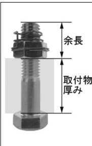
図1 チェンジロックナットの必要余長
