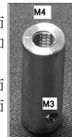
2. 写真4は真ちゅうの丸棒の側面にM3めねじと端面にM4めねじを加工しています。
