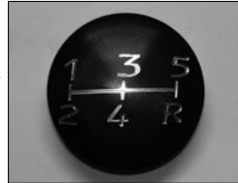
写真5 シフトノブ用球面文字板
