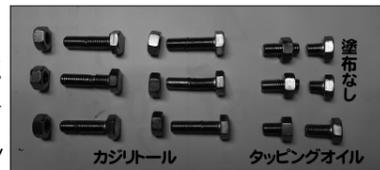
写真7 検証結果(M8x30ステンレス製ボルト・ナットを使用)
