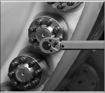
写真2 スーパーボルトの施工
