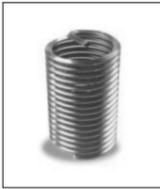
インサートは相手母材のタップ穴よりひと回り大きく造られていますので、軽く絞り込まれながら装着されます。装着後はバネ作用がはたらいて抜けません。
