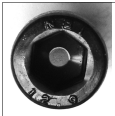
写真5 強度区分12.9の刻印(M10)
