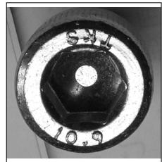
写真6 強度区分10.9の刻印(M10)
