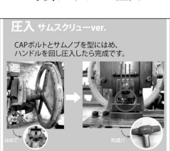
写真6 サムノブの圧入作業
