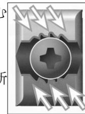
図1 ガッチリ食い込む溝形状
