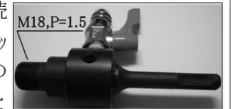
です。写真1は 使用されるコアビットドリル用シャンクで、接続径は「M18 ピッチ1.5」で、ネジの直角方向から潤滑用の水が供給できるようになっています。このシャンクをそのまま使用して、接続径が「M22 ピッチ2.5」のコアビットドリルを接続する(左下へ)
