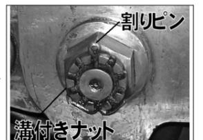
写真4 蒸気機関車可動部の溝付きナットと割りピン
