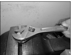
写真10 スパナを使用し緩め方向にトルクを掛ける
