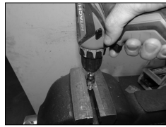
写真9 電動ドライバーでボルトを抜き差し
