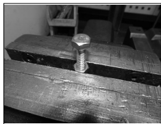
写真8 バイスでナットをはさみ、ボルトを通す
