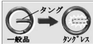
タングレスインサートは専用工具を使用することでタング無しで挿入・抜取が可能となり、施工後折れたタングが商品内部に混入することもありません。
