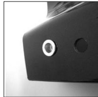
写真3 施工後のエビローレットナット
