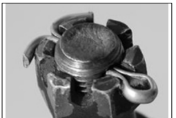
写真2 割りピンの使い方(棚旭ノ本金属工業所様のHPより引用)
