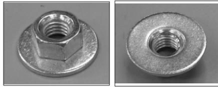
ナットと座金部分は「カシメ」で固定されています(皿バネナットのように回すことはありません)。また、座面を広く取っているので締付の力が分散され、締付箇所の変形等を防ぐ効果もあります。
