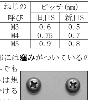
写真3 ナベ小ねじM5×12頭部比較、左：旧JIS、右：ISO
