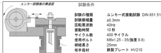
図1 ユニカー振動試験機構造図
