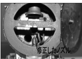
写真7 応急処置をした排気ノズル
