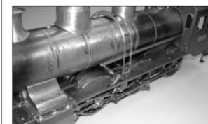
ボイラハシゴ、煙突、砂箱、蒸気ダメドーム、蒸気管おおい、逆転棒等の装飾部品が見えます。
