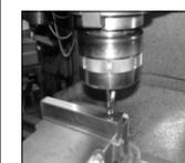
写真9 立フライス盤でのエンドミルによる加工
