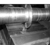
写真10 横フライス盤でのメタルソーによるすりわり加工
