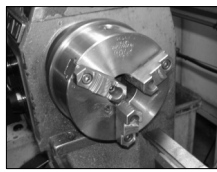
写真14 三爪（スクロール）チャック
