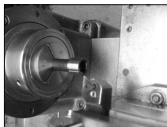
写真3 端面、外径切削
