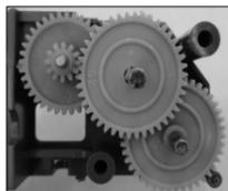
写真3 クレーン用ギヤボックス
