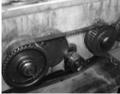
写真5 旋盤に使われているタイミングプーリー
