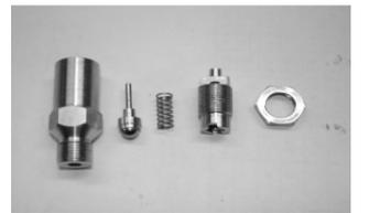
写真3 安全弁の部品
