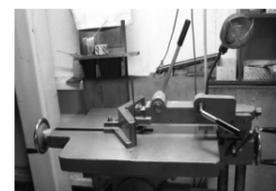
写真5 キー溝加工機
