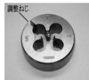
その調整ねじでねじ径を僅かに拡大したり縮小したりすることができる。ねじ切り用として、最も多く使用されているタイプ。
